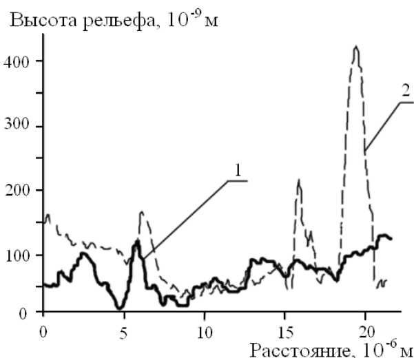
Рис.2. Микрорельеф поверхности мембраны МК-40, полученный методом АСМ. Образцы мембраны: после кондиционирования (1) и после термообработки в воде при 100°C в течение 50ч (2).
