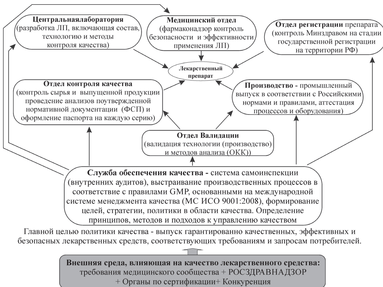
Рис.3. Концептуальная модель системы управления качеством ЛП на фармацевтическом производственном предприятии
