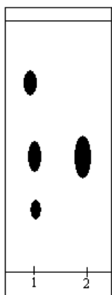
Рис. 1. Исследование дубильных веществ травы горца методом ТСХ: 1 – исследуемая вытяжка, 2 – РСО танина
