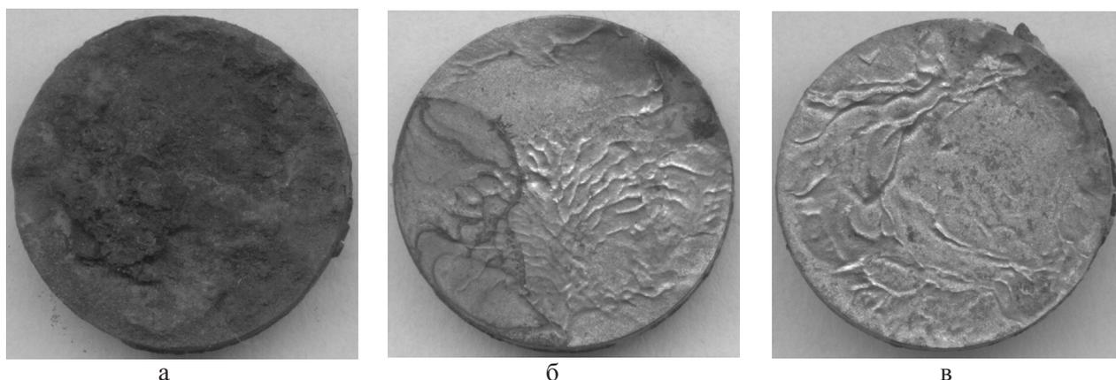
Рис. 2. Фотографии срезов с торца анода. Обозначения: концентрация NaCl, %: а – 0.05, б – 1.0, в – 3.0
