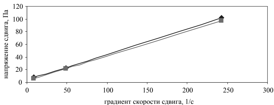
Рис. 2. Кривая зависимости напряжения сдвига от скорости сдвига пластырной массы ТТС 2
