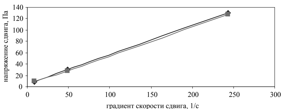
Рис. 3. Кривая зависимости напряжения сдвига от скорости сдвига пластырной массы ТТС 3
