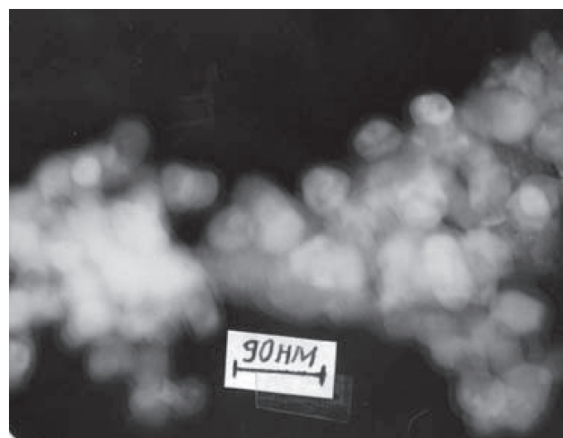
Рис. 6. Микрофотография нанопорошков YFeO_3 , полученных золь-гель методом, после обработки при 650 °С в течение 1ч. 20 мин.
