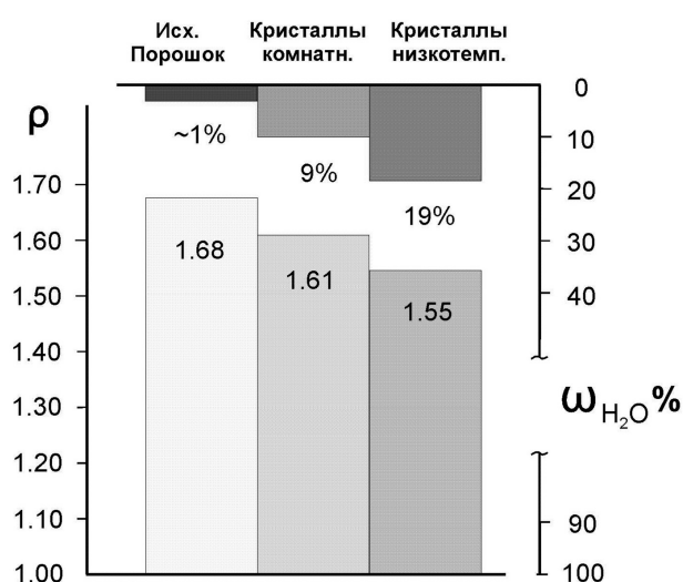
Рис. 1. Плотность и содержание воды в кристаллах триглицинсульфата, выращенных при различной температуре, и в исходном порошке
