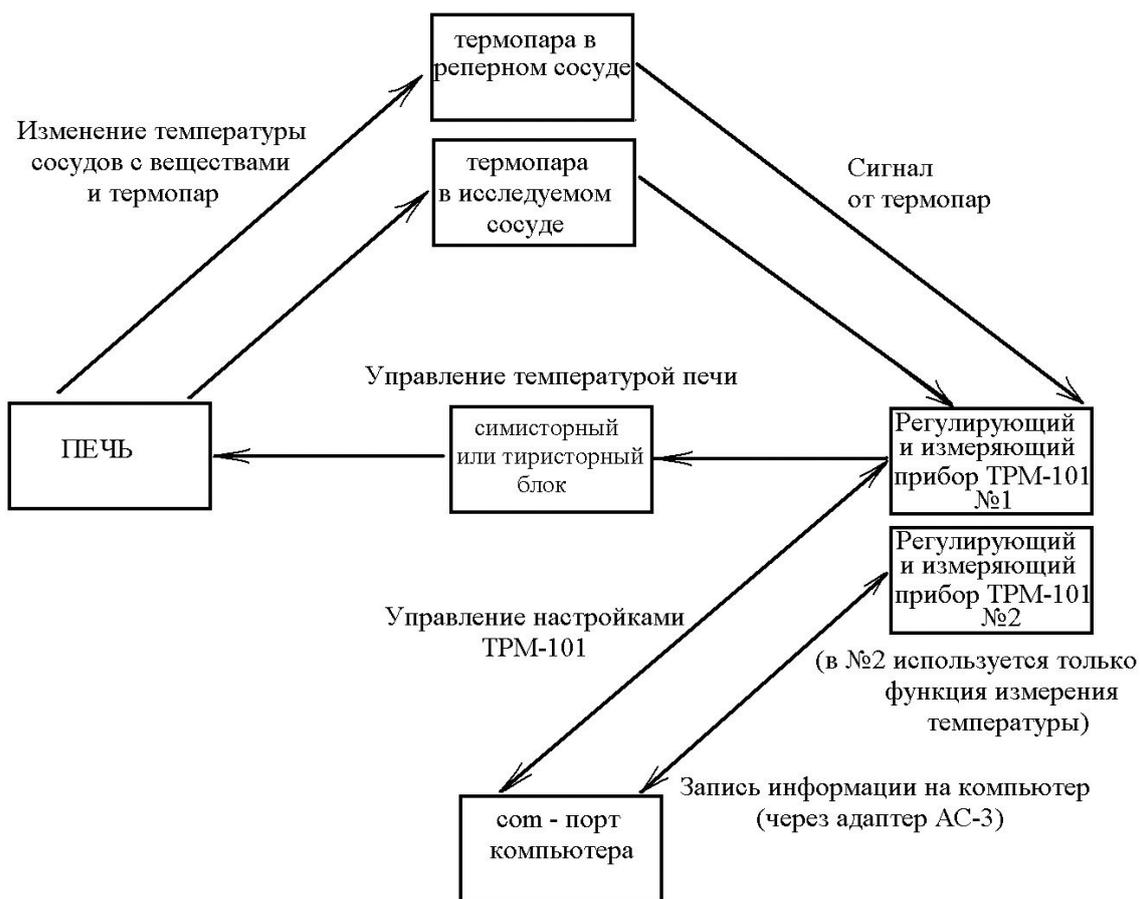
Рис. 2. Блок-схема созданной установки ДТА
