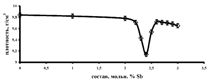
Рис. 4. Концентрационная зависимость плотности твердых растворов Bi-Sb.
