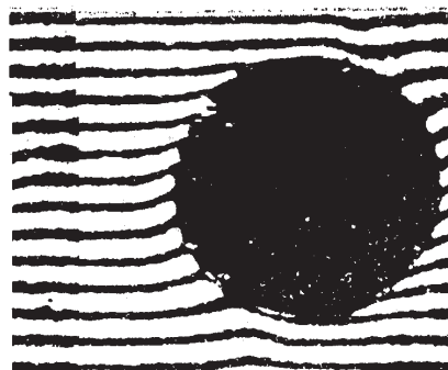
Рис. 6. Интерферограмма гранулы катионообменника в растворе 5,0 \cdot 10^{-2} моль/л сульфата меди при протекании постоянного электрического тока с плотностью 100 \text{ A/m}^2
