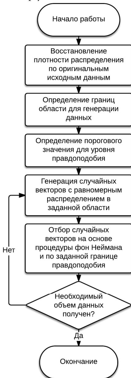
Рис. 1. Блок-схема предлагаемого алгоритма искусственного размножения данных
