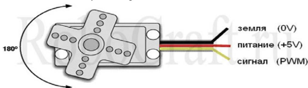
Рис. 4. Схема подключения сервоприводов
