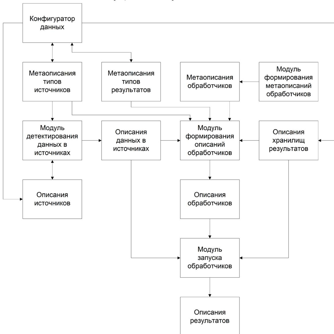
*Рис. 5. Структурная схема программной платформы обработки данных*
