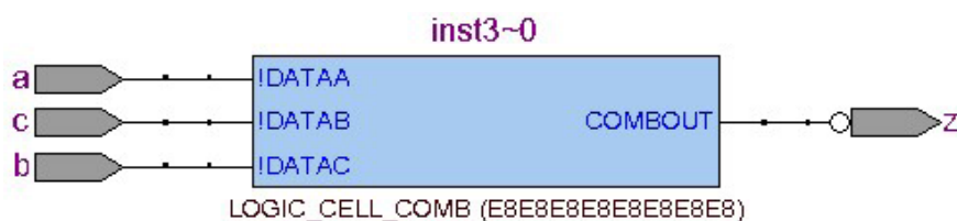
Рис. 10. Technology Map Viewer (Post Mapping) для схемы на ПЛИС Stratix IIGX
