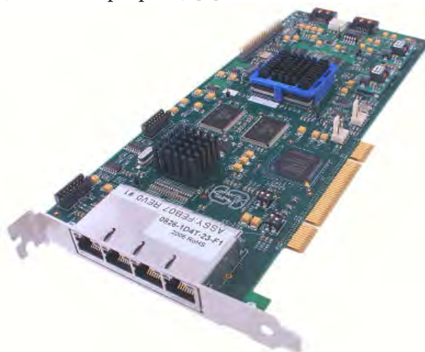
Рис. 1. Фотография репрограммируемой платформы NetFPGA
