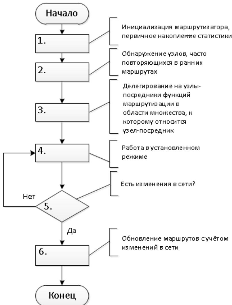
Рис. 2. Схема работы алгоритма самоорганизации сети
