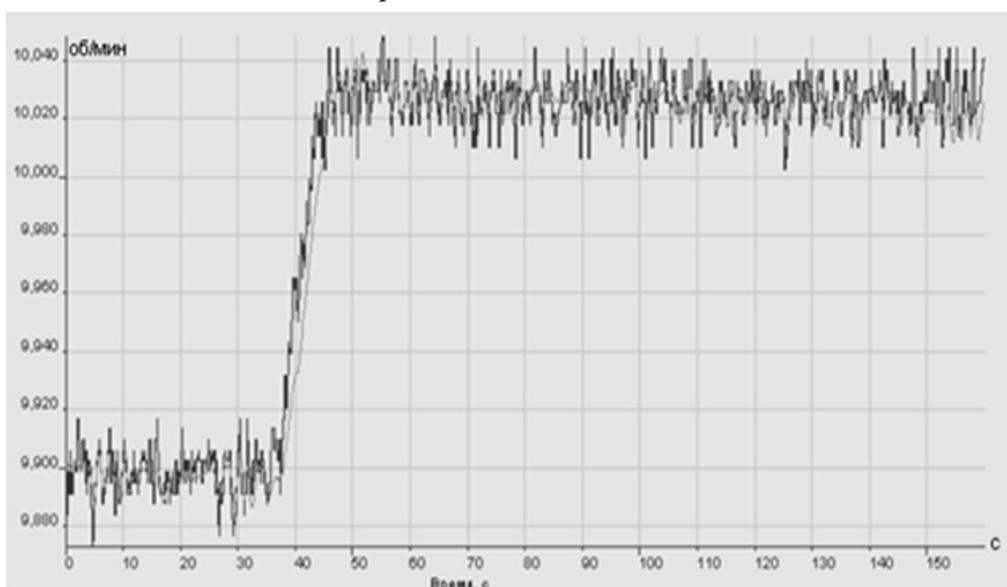
Рис. 5. Переходный процесс скорости вращения турбокомпрессора (темная – экспериментальная, светлая – модельная)
