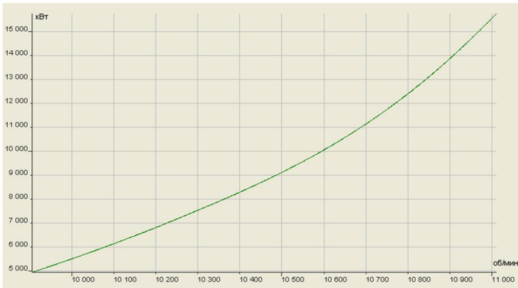
Рис. 3. Зависимость вырабатываемой мощности от скорости вращения турбокомпрессора, интерполированная кубическим сплайном
