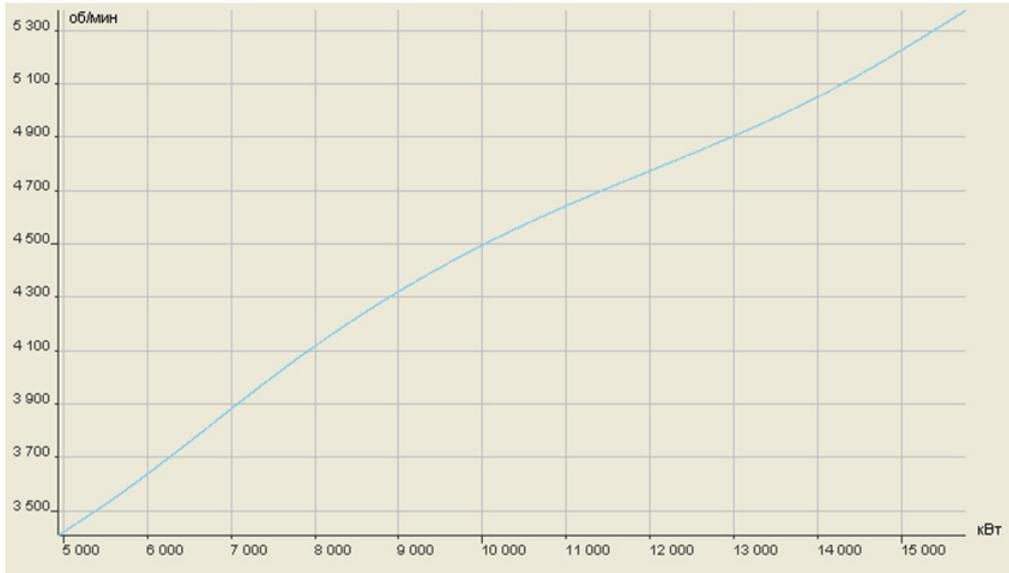
Рис. 2. Зависимость скорости вращения свободной турбины от мощности, интерполированная кубическим сплайном
