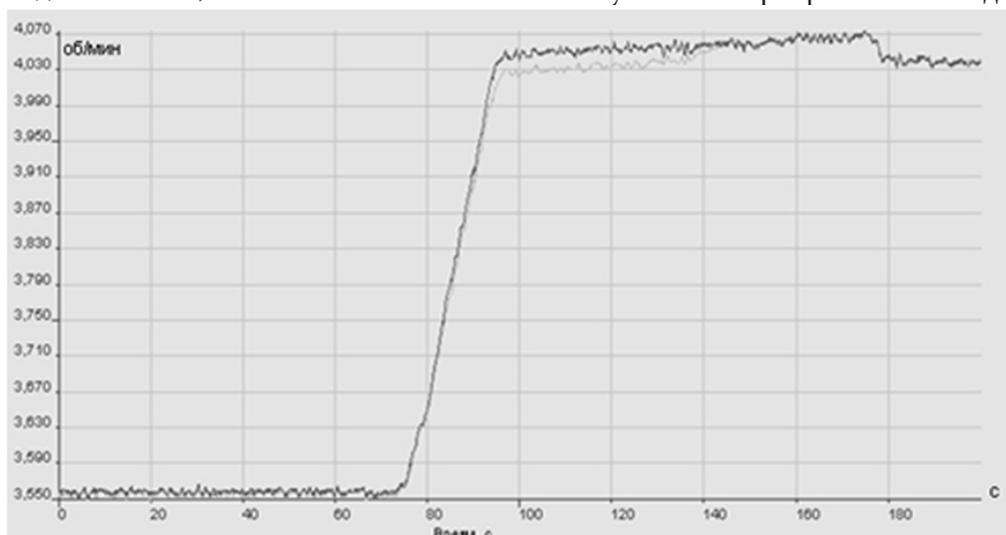
Рис. 4. Переходный процесс скорости вращения свободной турбины (темная – экспериментальная, светлая – модельная)
