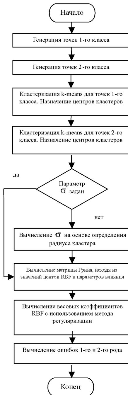
Рис. 3. Блок-схема алгоритма обучения классификатора
