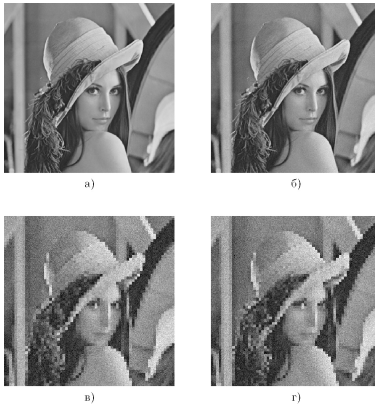
Рис. 5. Повышение разрешения изображений в 4 раза: а) исходное оцениваемое изображение; б) восстановленное изображение; в), г) НР-кадры, полученные из исходного ВР-изображения. Изображения в), г) смещены друг относительно друга на 0.25 пикселя. Величина шума: \sigma_R = 0.05
