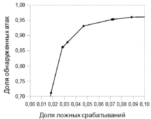
Рис. 5. Соотношение числа обнаруженных атак и ложных срабатываний для логарифмического классификатора
