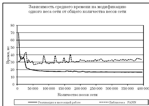
Рис. 6. Зависимость среднего времени модификации одного веса нейронной сети от общего количества весов
