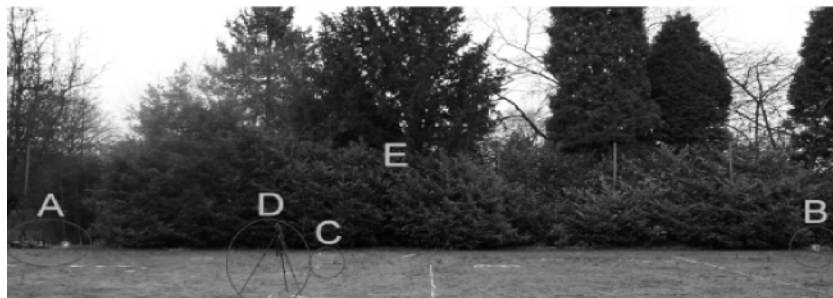
Рис. 1. Вид-схема эксперимента. А — блок приёмника, В — передающая антенна (передатчик), С — анемометр, измеряющий скорость и направление ветра, D — видеокамера
