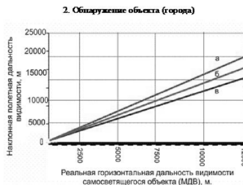
Рис. 4. Зависимость НПДВ самосветящегося объекта от РГДВ при различной естественной освещенности (путевая скорость ВС 100 км/ч, высота полета ВС 200 м, ВНГО 800 м, IV ТОМ). а) E=0,3 \cdot 10^{-7} Лм. б) E=0,14 \cdot 10^{-7} Лм. в) E=0,4 \cdot 10^{-8} Лм. г) E=0,1 \cdot 10^{-8} Лм. д) E=0,7 \cdot 10^{-9} Лм
