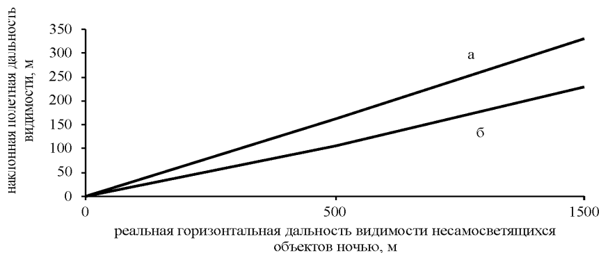
Рис. 1. Зависимость НПДВ от РГДВ несамосветящихся объектов в темное время суток при полете над равнинной местностью III класса ( W = 200 \text{ км/ч} , H_{\text{пол}} = 300 \text{ м} , ВНГО = 400 \text{ м} , \varepsilon = 0,2 ). а) глянцевая поверхность; б) матовая поверхность
