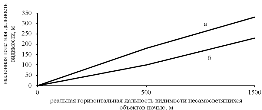
Рис. 2. Зависимость НПДВ от РГДВ несамосветящихся объектов в темное время суток при полете местности над равниной местностью I класса ( W = 200 \text{ км/ч} , H_{\text{пол}} = 300 \text{ м} , ВНГО = 400 \text{ м} , \varepsilon = 0,2 ). а) глянцевая поверхность; б) матовая поверхность
