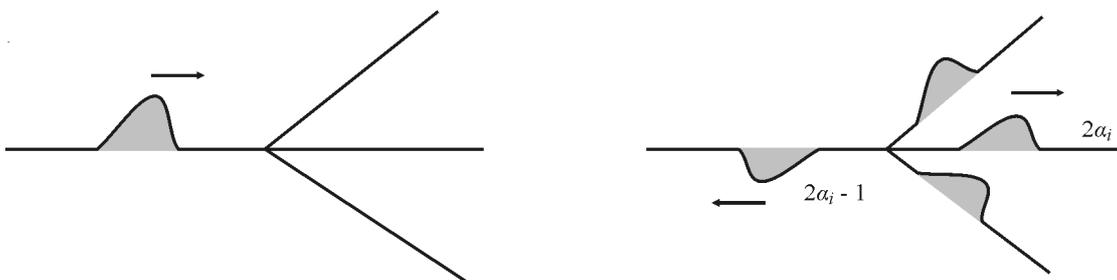
Рис. 1. Прохождение волны через узел
