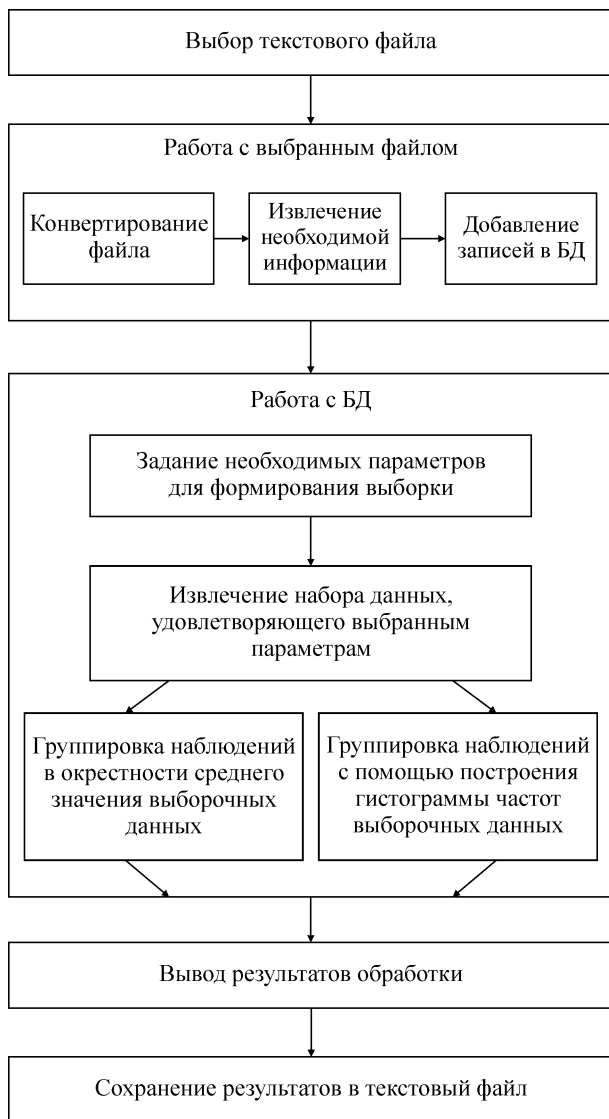
Рис. Схема обработки данных в программе формирования выборок и анализа состояния железнодорожных путей
